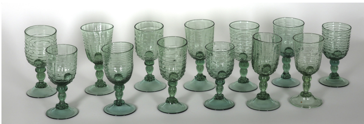
Bild 32 och 33: Projektresultat från testtillverkning av olika arbetsmetoder. The Glass Factory 2021. Glasens storlek och tjocklek överensstämmer inte med originalet. Här är måtten betydligt grövre och större. Foto Anki Lütz 2023.
