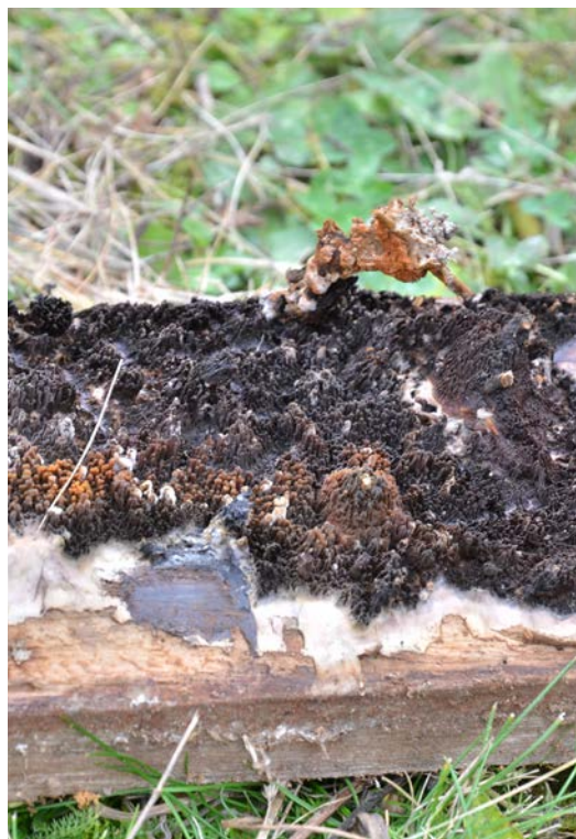
Bild 13. Undersida på en av de angripna golvbrädorna. Foto 2021-10-25. SLM D2021-0587.
