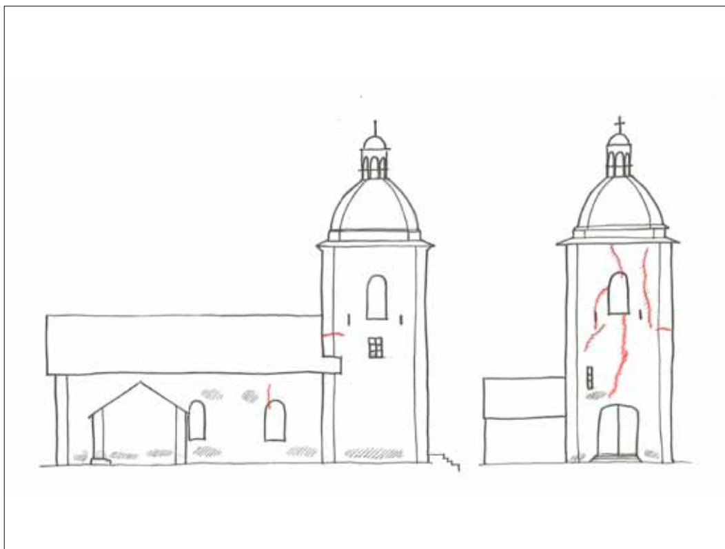
16 Skiss av Vagnhärads kyrkas norra och västra fasad. Röd markering är sprickor och putsskador och skrafferingar markerar entreprenörens lagningsdokumentation. Skiss Eva Wockatz.
