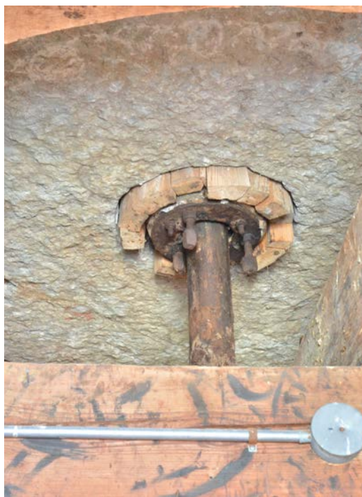
Stödlager mellan nål och kvarnsten. Bilden visar kvarnstenens undersida. SLM D2022-0679.
