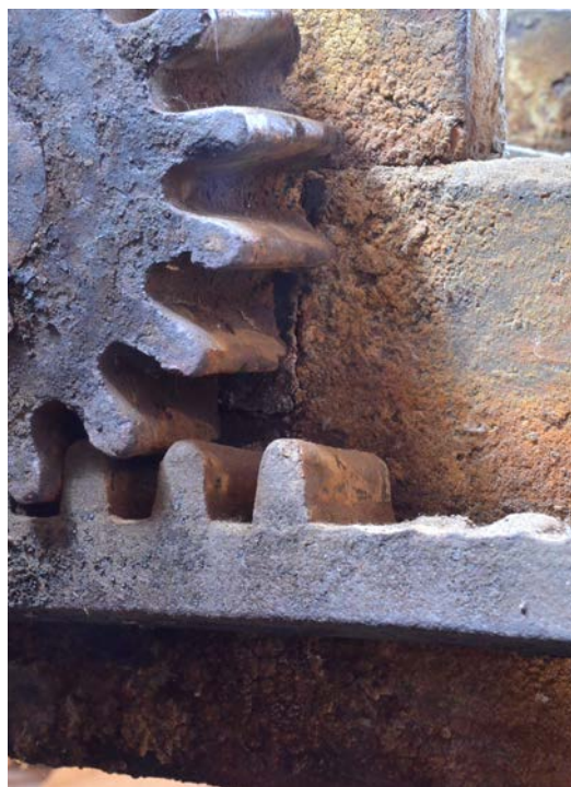
Trasiga kuggar som gör att hättan inte kan vridas. SLM D2022-0675.
