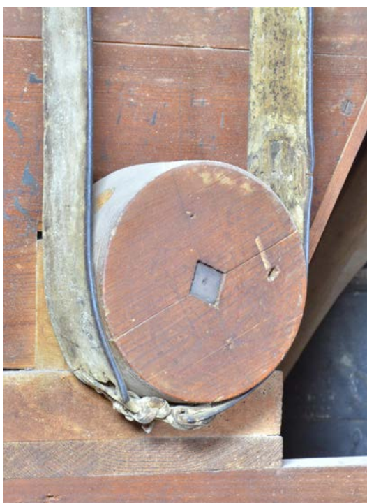
Drivrem av djurhud på en av mjölsiktarna. SLM D2022-0683.
