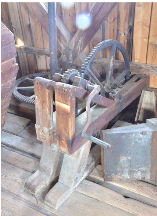
Spel med handvev för vridning av hättan. Det trasiga kugghjulet är det vågräta med en lodrät järnaxel i. SLM D2022-0674.
