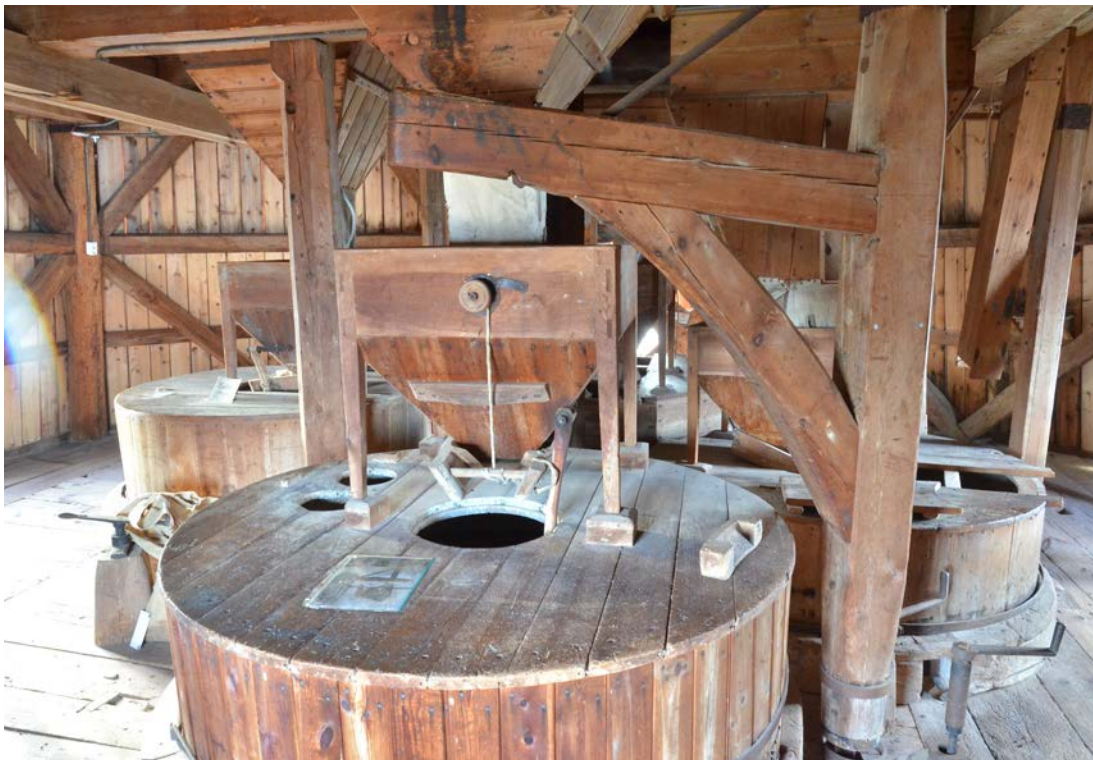
Tredje våningen rymmer de fyra kvarnkaren med kvarnstenarna. Ovanför karen syns kuphästarna och ovanför dessa kvarntrattarna. Under kuphästarna finns en skopa som med hjälp av vibrationer/skakningar från kvarnstenarna ger en jämn tillförsel av säd. Med vevarna av järn i golvet justeras avståndet mellan kvarnstenarna. SLM D2022-0669.
