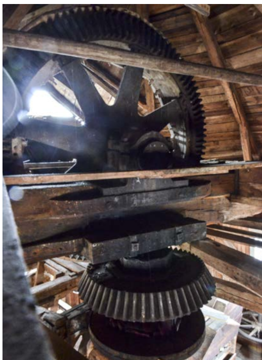
Vinkeldrevet i hättan, där kraften från vingarna via vingaxeln överförs till hjärtstocken. SLM D2022-0678.
