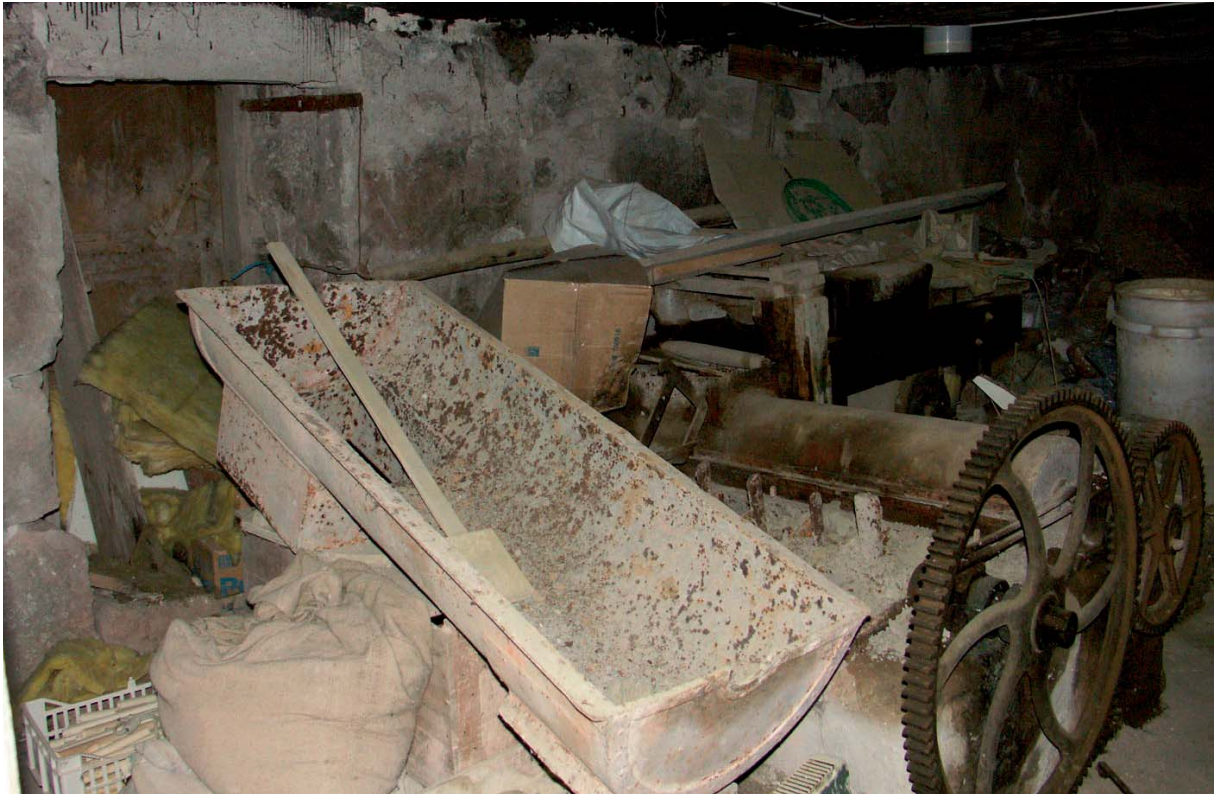
Bild 36. Leran tas in genom öppningen. Slammaskinen där leran krossas i metallvalsar och sedan slammas till lervälling i tråget.
