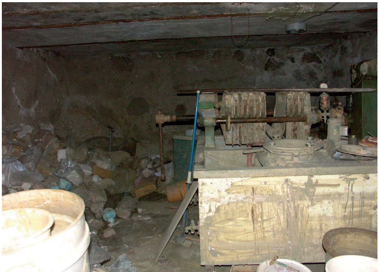
Bild 37. Filterpressen som slammade leran, för att få tillbaks rätt konsistens. Ramar sitter efter varandra.
