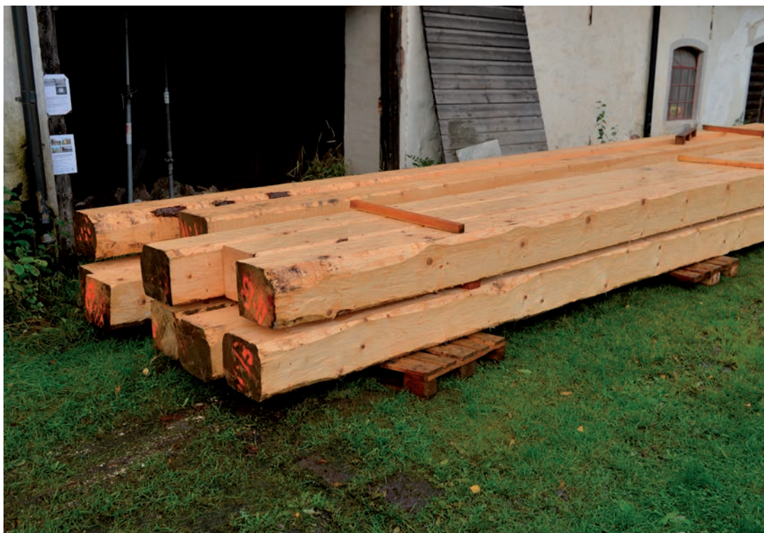
De nya bjälkarna till kostallet. Bjälkarna är av gran och har en del vankant. Tre av sidorna är handskrädda. (SLM D2019-0090)
