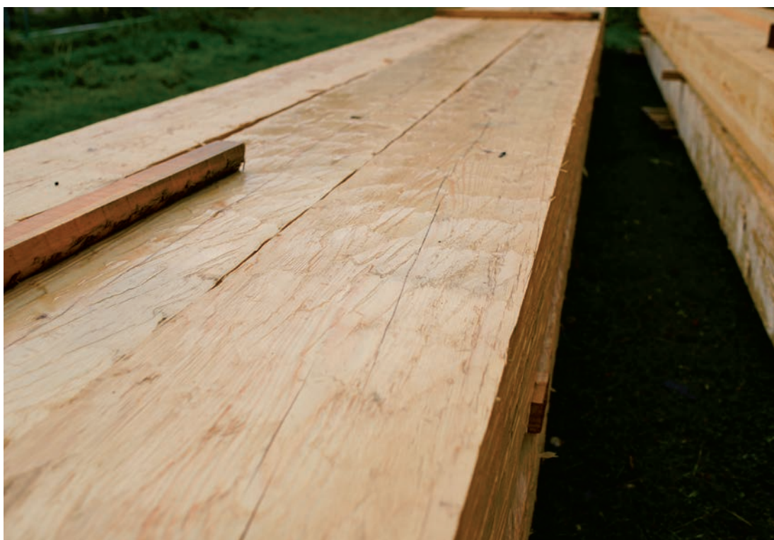
Närbild av en handskrädd sida. (SLM D2019-0091)
