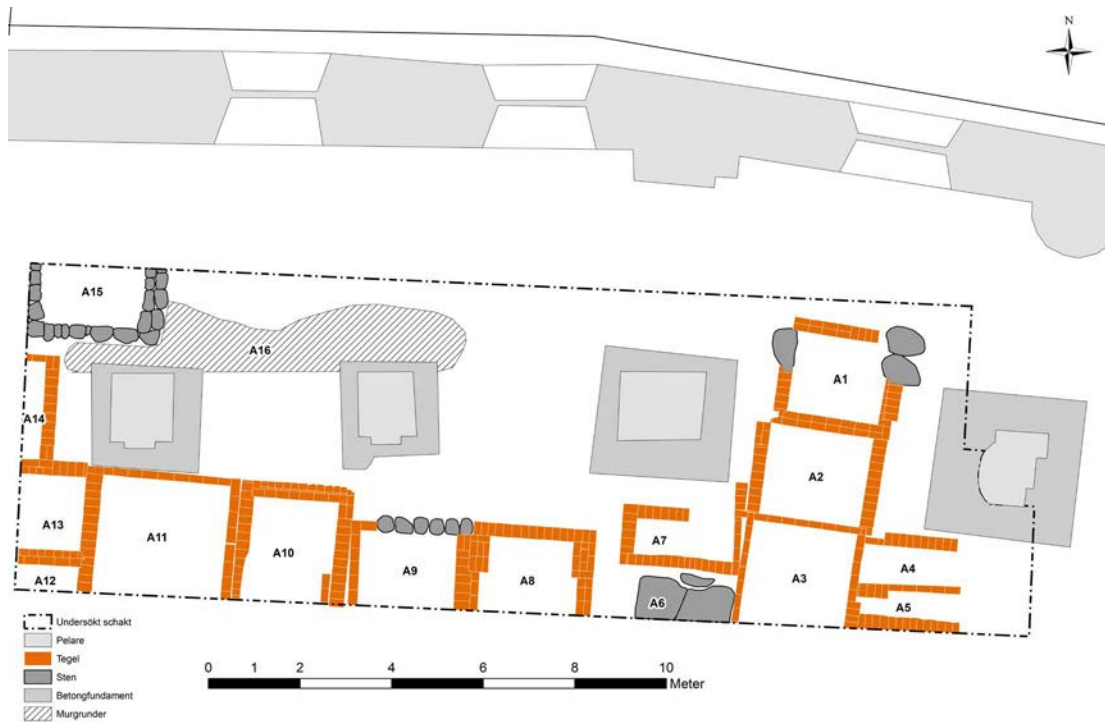
Figur 8. Planritning över det undersökta schaktet med gravkammare A1-A15. Kamrarna var uppförda av sten och tegel, murade med kalkbruk och med putsade insidor. Ytterligare en anläggning A16 frilades vid schaktets norra kant. En 9x2 meter stor yta med lösa stenblock, 0,5-1 meter stora, några med spår efter kalkbruk. Rester efter grundmurar till kyrkans äldsta byggnadsskede från 1200-talet.
