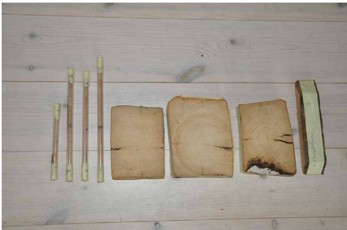
Sammanlagt togs åtta prover. De fyra borrhärnorna till vänster från södra respektive norra remstycket. De tre mittre sågskivorna från olika takstolsdelar, och sågskivan till höger från en undertaksbräda. Fotografi: Daniel Eriksson
