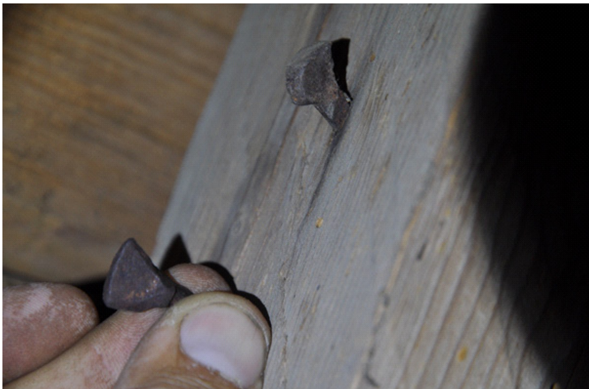
Jämför med spiken från Knista. En skillnad är att den rektangulära klingan sitter på tvären i förhållande till skallen, på spiken från Knista. Fotografi: Daniel Eriksson
