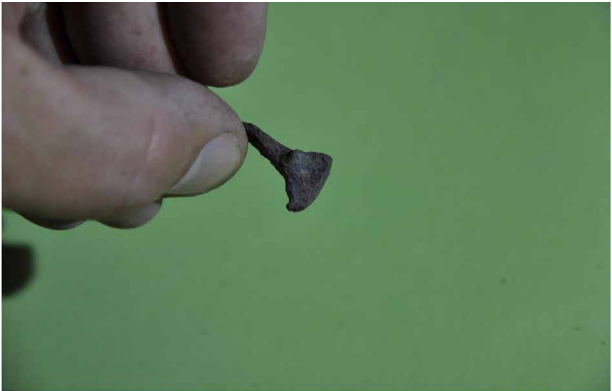
Spiken sitter precis som i de andra kyrkorna löst islagen, och går lätt att ta ut med handkraft. Fotografi: Daniel Eriksson
