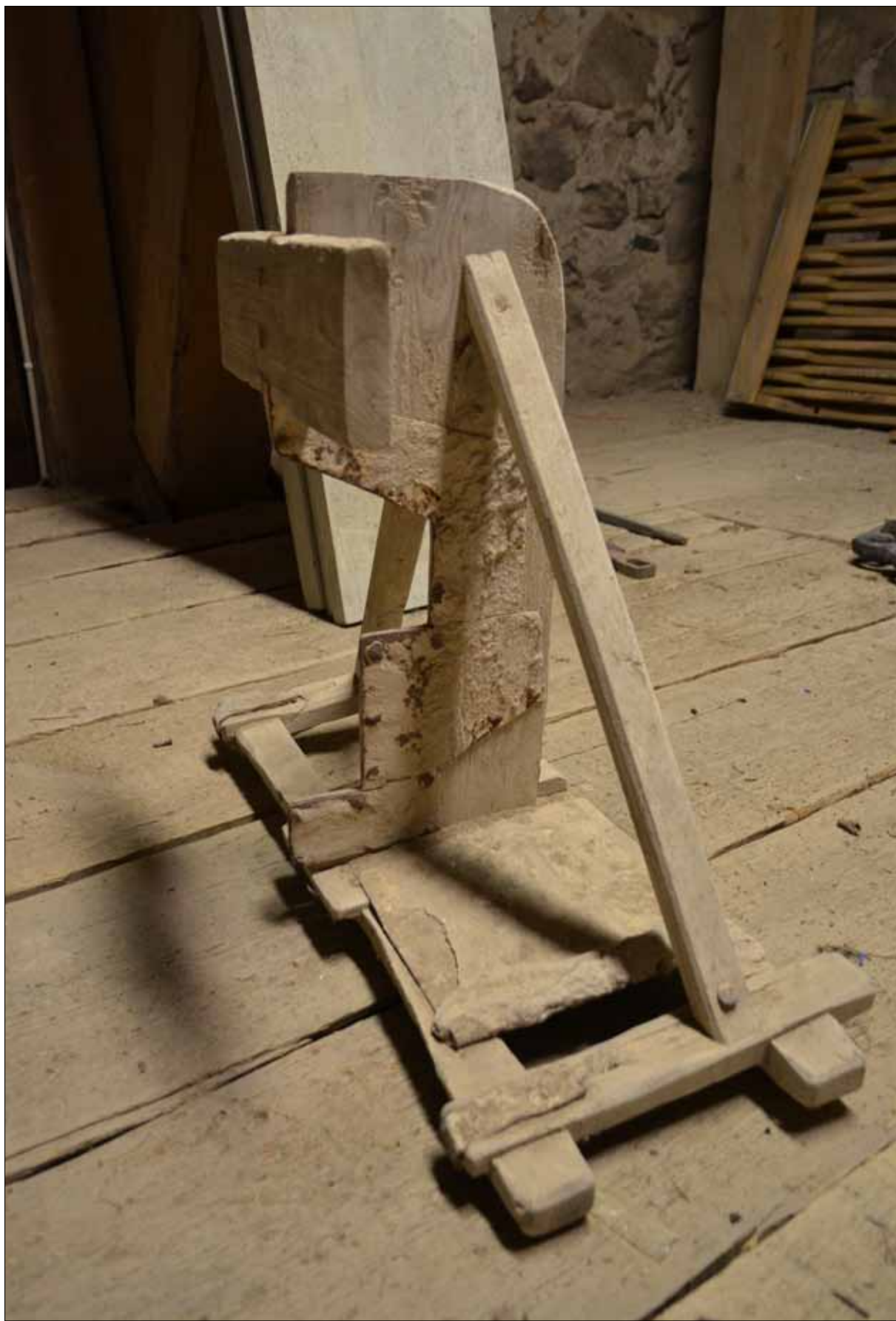
256 Putsprofilmall på vinden i Svärta kyrka (SLM D2015-1527).
