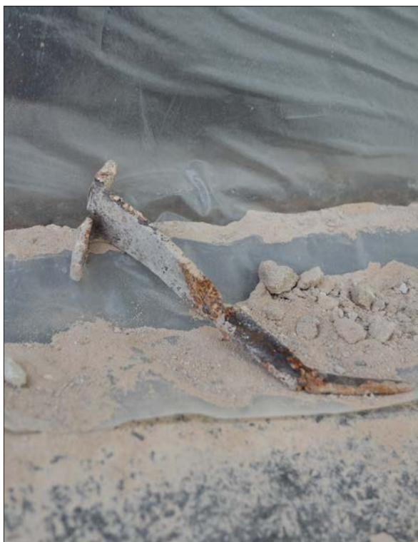
12 Detalj av en av de borttagna järnkramlorna (SIm D2013-864).
