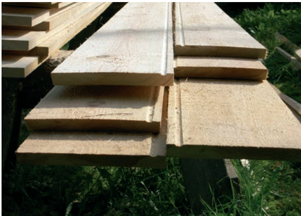
Bild 38. Nya täckbrädor med frästa vattenspår.
