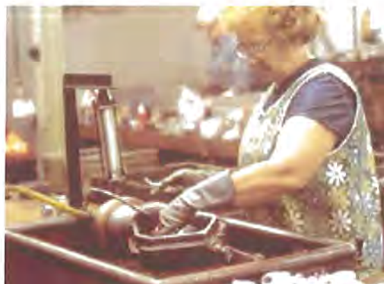
9. Provtryckning pågår, 1970-tal (Foto: Hälleforsnäs bruksmuseum)
