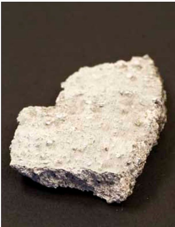
7 Detalj av putsbit från valv 1. Den grova slamningen och avfärgningen kan anas. Fotografi Anki Lütz, Sörmlands museum. (D10-903)
