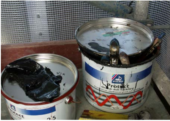
Bild 11. Fönster nr 9 målades med färg av alkydolytyp.
