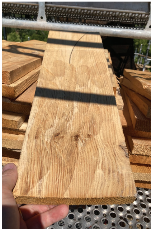
Bild 21. Nytt takspån med till synes mer kådrikt virke än vad spånet på föregående bild innehåller. Foto 2024-06-25. (SLM D2024-0467)
