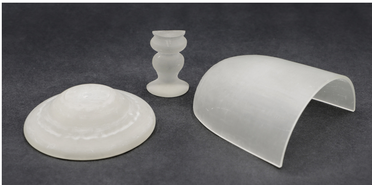
Bild 24. Formmakaren använde vår tids teknik och 3d-printade först formerna till vinpokalen för godkännande innan originalformerna tillverkades. En form måste tillverkas något större än den färdiga produkten då glas krymper något i tillverkningsprocessen. Foto Anki Lütz. 2023.
