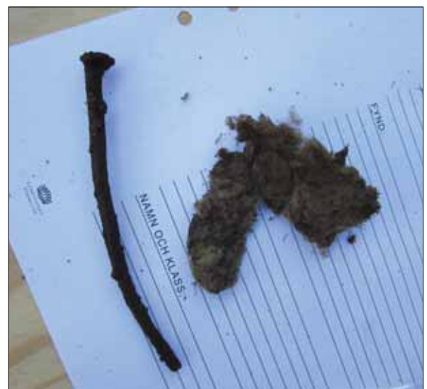
Figur 13. En handsmidd spik och en bit isoleringsmaterial. Foto: Sören Filipsson 2012, Sköldinge skola.
