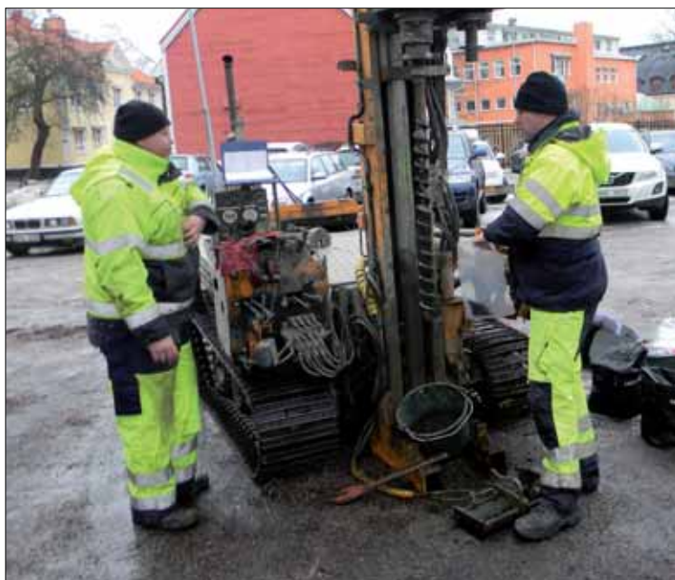
Figur 3. Provtagningen gjordes med maskin-driven skruvborr där den kvarsittande jorden i skruven dokumenteras i ett borrprotokoll. Skruvborrens diameter var cirka 7 cm. Foto: Patrik Gustafsson 2012, Sörmlands museum.
