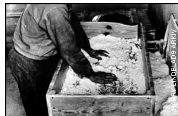
Rivning av nitrocellulosa.
