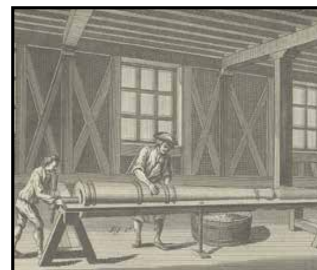
En modell av kanonen tillverkades därefter med hjälp av lera som formades runt kärnan.
