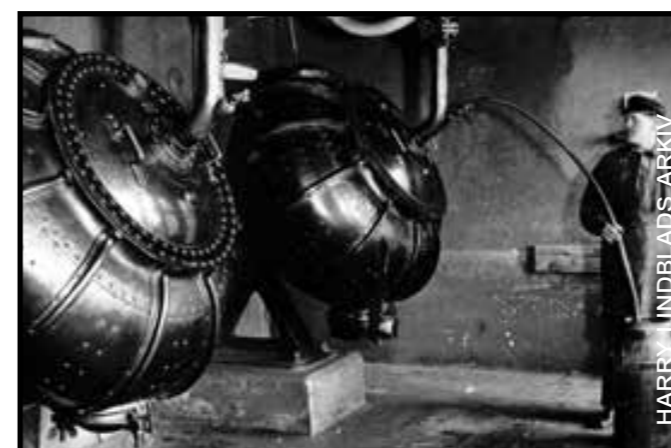
I den roterande polertrumman blandades krutet med grafit.
